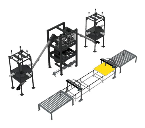
我们的机器由两个筒仓或大袋站组成,用于储存混凝土预混料,两个大功率的双轴搅拌机用于搅拌混凝土,一个混凝土泵和一个线性轴应用工具,将材料射入用传送带运输的模具。
